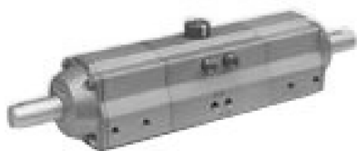
3-х позиционные пневмоприводы с промежуточной регулируемой позицией: двойного действия с величиной поворота выходного вала 90^\circ , 120^\circ , 180^\circ одностороннего действия с величиной поворота выходного вала 90^\circ
